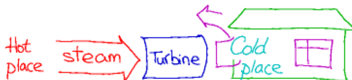
Fig.21.9: Kraft-Wärme-Kopplung. Fernwärme nimmt die Wärme auf, die andernfalls im Kühlturm verblasen würde.
