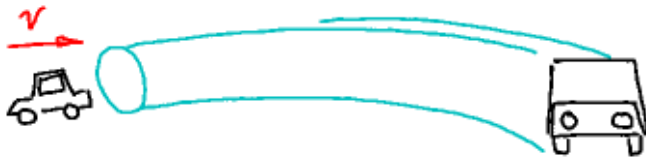
Fig.A.3: Ein Auto mit Geschwindigkeit v erzeugt hinter sich eine Röhre wirbelnder Luft. Der Querschnitt der Röhre ist ähnlich der Aufstandsfläche des Autos und die Geschwindigkeit, mit der die Luft wirbelt, ist annähernd v .
