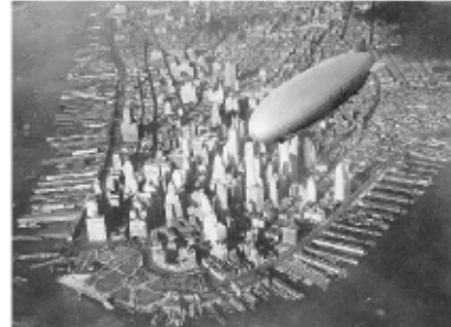
Fig.C.14: Die 239 m lange USS Akron (ZRS-4) über Manhattan. Sie wiegt 100 t und könnte 83 Tonnen zuladen. Die Gesamt-Maschinenleistung ist 3,4 MW, sie befördert 89 Mann Besatzung mit Waffen bei 93 km/h. Sie wurde auch als Flugzeugträger eingesetzt.
