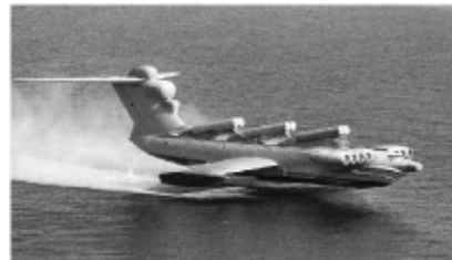
Fig.C.16: Das Lun Ekranoplan – etwas länger und schwerer als eine Boeing 747. Fotografien: A. Belyaev.
